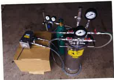
18ℓの加圧タンクで試作。実際は800ℓほどを一気に泡立てる。
